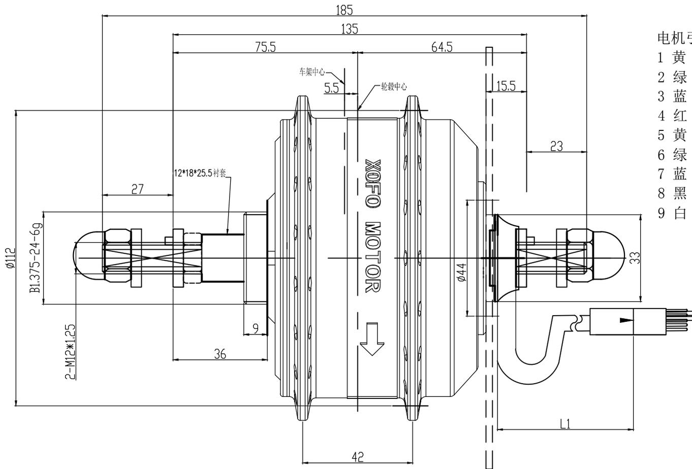
电机引出线接线头示意图（从进线端观之）
